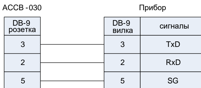
Рис.3. Подключение прибора по интерфейсу RS-232.
