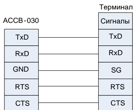
Рис.8. Схема подключения АССВ-030 к терминалу аппаратного управления потоком.
